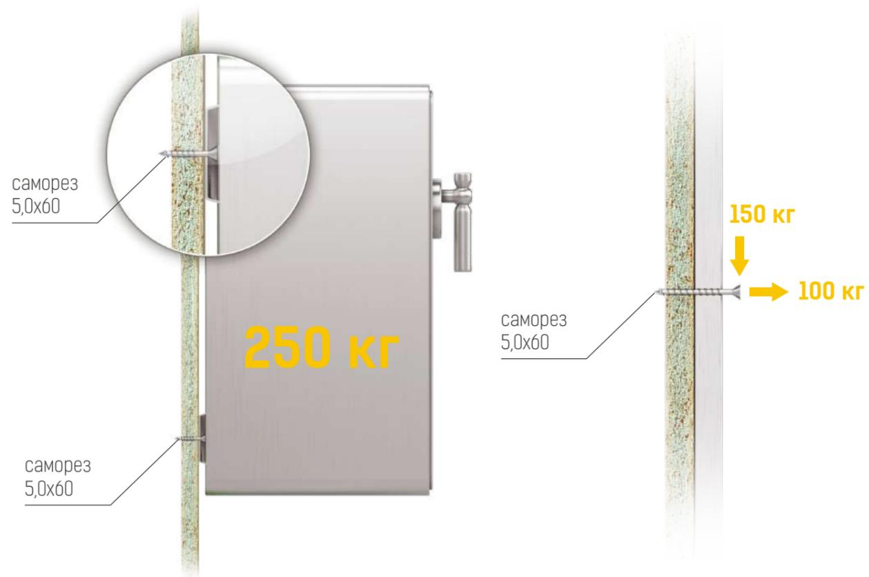
Благодаря **высокой плотности плит**, они являются отличным решением в случаях, где предъявляются повышенные требования к несущей способности стен.
